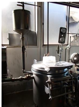
豆乳を型に入れ、にがりをさつと混ぜる固める型(きぬ豆腐)
